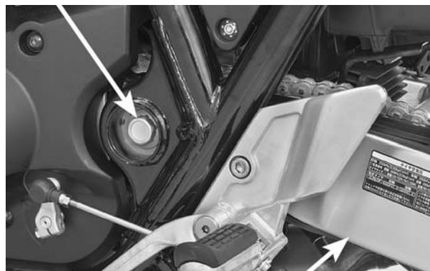
BRAÇO OSCILANTE GUIAS PARAFUSOS/ESPAÇADORES
