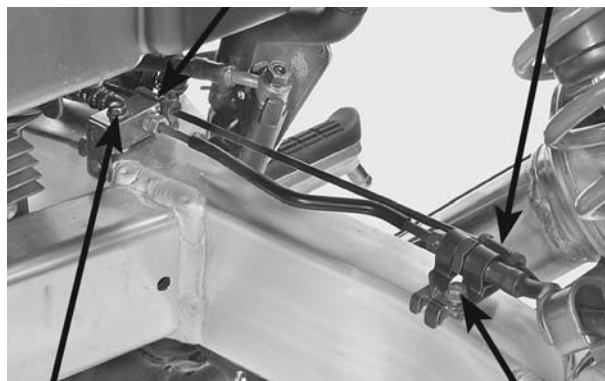
PARAFUSO PARAFUSO/PRESILHA DA MANGUEIRA CB1300/S: PRESILHA DA MANGUEIRA
