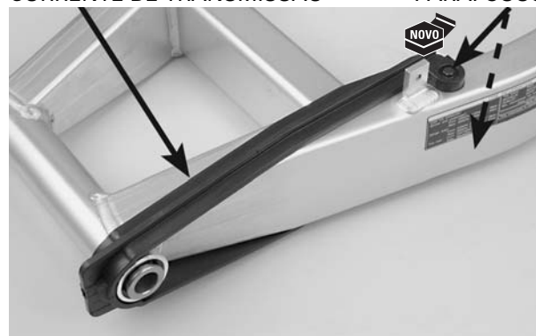
DESILIZADOR DA CORRENTE DE TRANSMISSÃO
