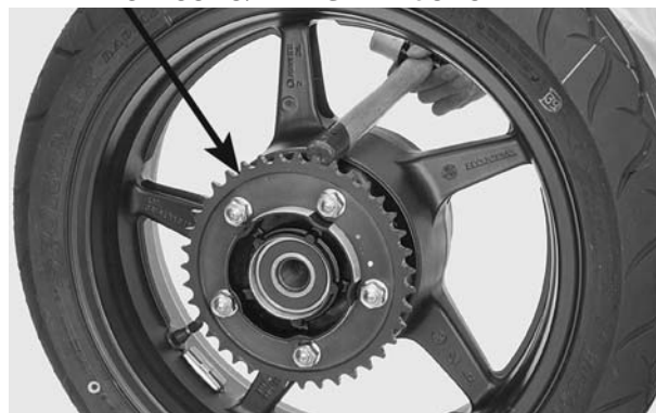
RETENTOR DE PÓ CONJUNTO DA COROA DE TRANSMISSÃO/FLANGE DA COROA
