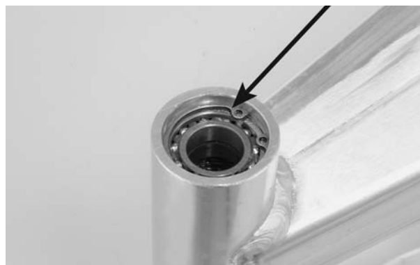
ACESSÓRIO/GUIA ANEL ELÁSTICO
