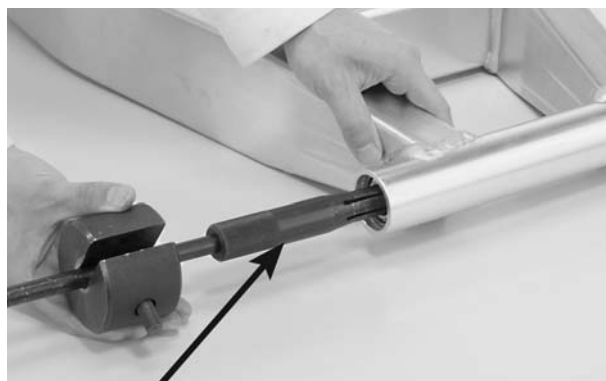
EIXO EXTRATOR DE ROLAMENTO
